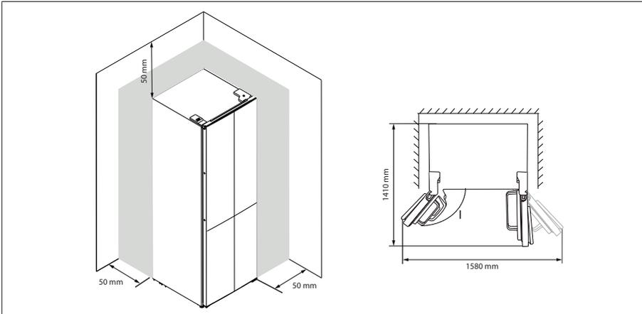
Appoggiate l'apparecchio su un pavimento solido in grado di sopportarne il peso anche quando è pieno. Evitate di appoggiarla su materiali elastici e risonanti che ne amplificherebbero il rumore. Regolate bene il livello orizzontale con gli appositi piedini.
