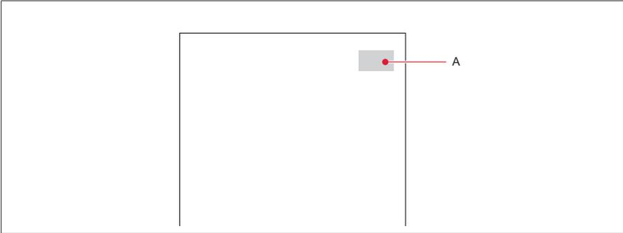
Essa contiene il modello, il numero di serie e tutti i dati tecnici della macchina.
