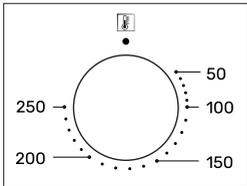
**Manopola termostato:** permette di impostare la temperatura di cottura del cibo da cuocere in forno.
