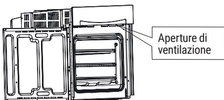
La ventola di raffreddamento permette la fuoriuscita del flusso d'aria extra e impedisce alle superfici esterne dell'apparecchio di surriscaldarsi durante il funzionamento. Questa è una condizione necessaria per un migliore funzionamento dell'apparecchio e una
