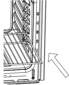
È importante posizionare correttamente la griglia metallica nel forno. Evitare che la griglia metallica tocchi la parete posteriore del forno. Le teglie possono essere posizionate tra il primo e il quinto ripiano, come mostrato nelle figure qui sopra. È possibile posizionare un vassoio profondo o un vassoio standard nei ripiani a filo inferiore e superiore.
