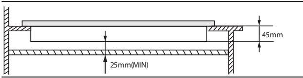
7. Quando montate il piano di cottura su un piano di lavoro dovete montare anche un ripiano tra il piano di lavoro e il piano di cottura per separarli nel modo indicato sopra. Se invece si monta sopra un forno ad incasso non è necessario.
