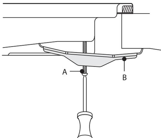
5. Ruotare nuovamente il piano cottura e allineare il supporto in una posizione idonea al bancone. Serrare tutte le viti per fissare il piano cottura.
