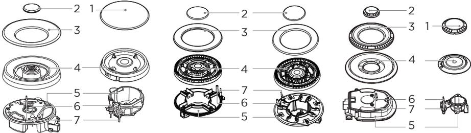
1. Posizionare la corona spartifiamma (4) sopra la coppa del bruciatore (5), in modo che il dispositivo di accensione e il dispositivo di controllo della fiamma si infilino dentro i rispettivi fori dello spargifiamma. Lo spargifiamma dovrebbe posizionarsi correttamente con uno scatto.
