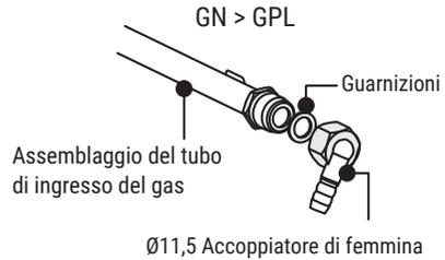
**ATTENZIONE:** Il tubo del gas e il collegamento elettrico dell'apparecchiatura non dovrebbero passare vicino ad aree calde quali ad esempio la parte posteriore del dispositivo. Il tubo del gas dovrebbe essere collegato solo compiendo rotazioni ampie per evitare di causare rotture. Il movimento dell'apparecchiatura alla quale viene collegato il gas potrebbe causare perdite di gas.
