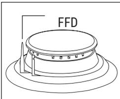
5. Dispositivo di sicurezza di interruzione della fiamma (FFD)\*; funziona istantaneamente quando il meccanismo di sicurezza si attiva a causa del liquido traboccato dai piani di cottura superiori.
