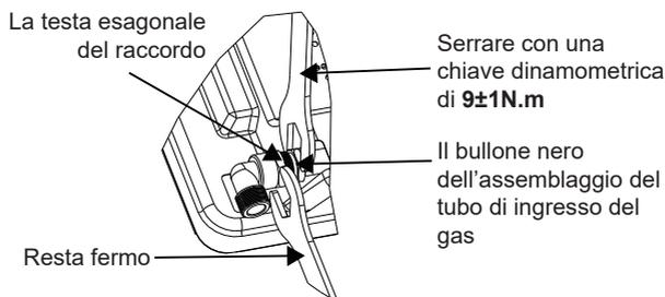
3. Dopo che è stato installato e serrato, controllare che le parti siano in buone condizioni e verificare la tenuta dell'aria per garantire la tenuta dell'installazione.
