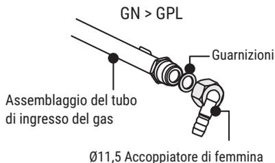
**ATTENZIONE:** Il tubo del gas e il collegamento elettrico dell'apparecchiatura non dovrebbero passare vicino ad aree calde quali ad esempio la parte posteriore del dispositivo. Il tubo del gas dovrebbe essere collegato solo compiendo rotazioni ampie per evitare di causare rotture. Il movimento dell'apparecchiatura alla quale viene collegato il gas potrebbe causare perdite di gas.
