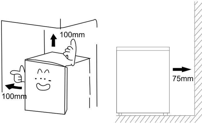
Appoggiate l'apparecchio su un pavimento solido in grado di sopportarne il peso anche quando è pieno. Evitate di appoggiare l'apparecchio su materiali elastici e risonanti che ne amplificherebbero il rumore.
